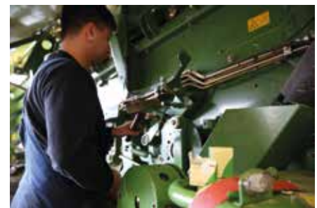
Willy Priepeke, monteur bij Marep, bouwt de nieuwe koppel in.
