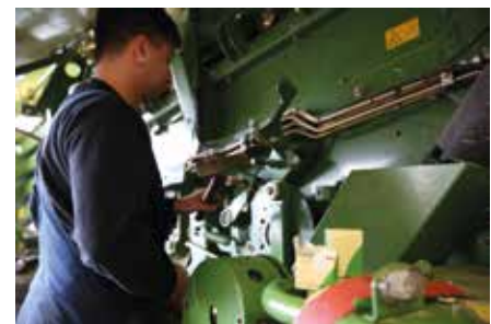
Willy Priepke, Monteur bei Marep, baut die neue Koppel ein
